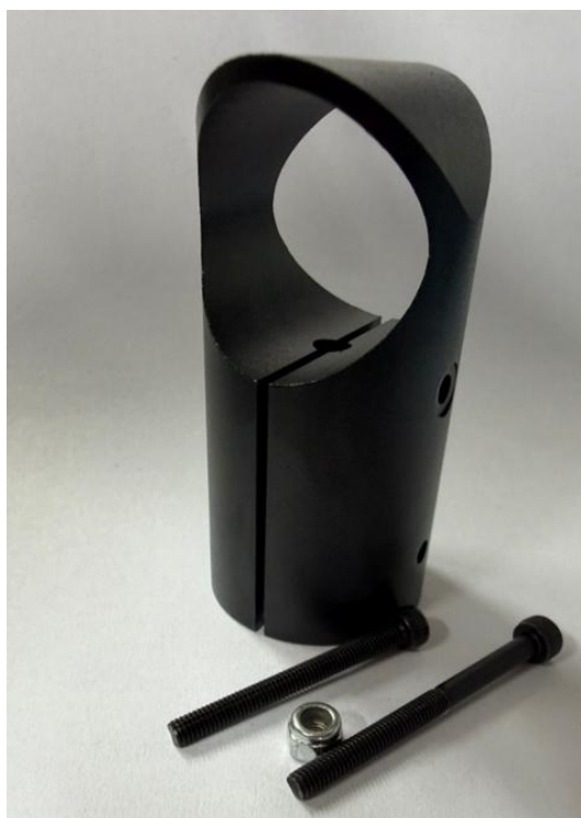
Fig. 23. Kit de fixation de pieds 2 pièces (embase de pied de tube 1 pièce, M3 x 35 mm 1 pièce, M3 x 30 mm 1 pièce, écrou M3 1 pièce)
