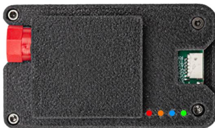
Rys.3. Wskaźniki LED modułu powietrznego
