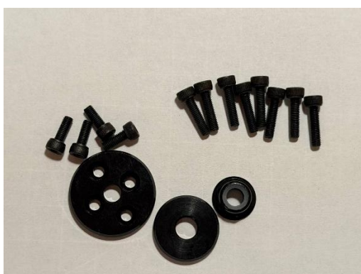
Rys. 12. Zestaw mocowania śmigieł (M3 x 8 mm 4 szt., M3 x 12mm 8 szt.)
